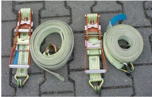
Abbildung 17: Spanngurte zur Befestigung
