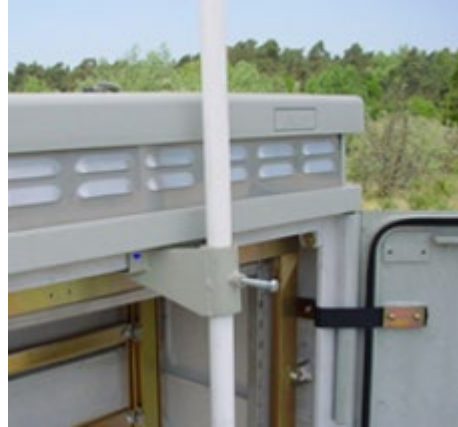
Abbildung 6: Schirmhalter im Einsatz
