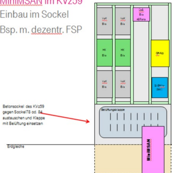
Abbildung 69: Beispiel für ein Einbauszenario mit einem mini MSAN
